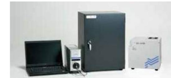
测量部分、检出部分、光源部分分别独立，各部分通用，在具备标准功能的基础上，可以根据用途进行扩展。
